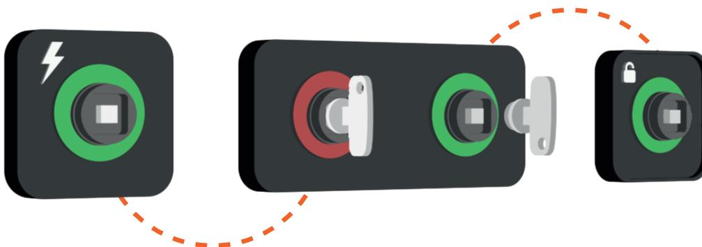
L'alimentation est isolée. La clé peut être retirée et apportée dans le boîtier de transfert de clé..
